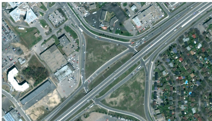
Рис. 5. Кольцевое пересечение в разных уровнях на пересечении автомобильных дорог 640 и 148 в Канаде, выполненное по типу распределительного кольца с двумя путепроводами
